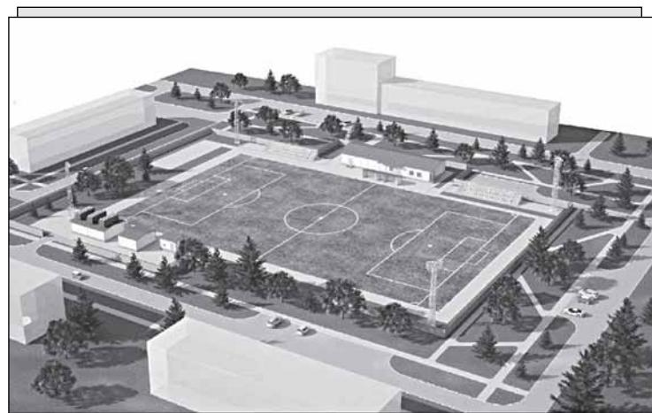
Проект многофункциональной спортивной площадки для русского хоккея и футбола, предоставленный компанией «Русэнергомонтаж»: 250 зрителей, поле для футбола 110x70 м, поле для русского хоккея с искусственным льдом 65x105м. Стадион рассчитан на эксплуатацию хоккеистами при температуре наружного воздуха не выше +10 градусов (с ноября по март) и футболистами при температуре выше +10 (с апреля по октябрь):
